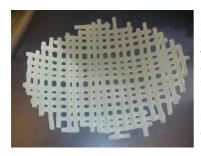
Glasfusing, das Zusammenschmelzen verschiedener Glasstücke im Spezialofen, ist eine seit 200 v. Ch. bekannte Technik. Schon damals wurden Glasstangen zu Schalen verschmolzen. In den letzten Jahrzehnten wurde das Verfahren weiterentwickelt und um neue Möglichkeiten bereichert. Hinter dieser Technik verbirgt sich nicht nur der Schmelzvorgang von Glasstücken als erster sondern auch das Formen der Glasstücke als zweiter Arbeitsschritt.
